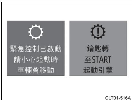
3. 檢查「緊急控制已啟動，請小心起動時車輛移動」和「鑰匙轉至 START 起動引擎」是否出現在資訊顯示幕上。
