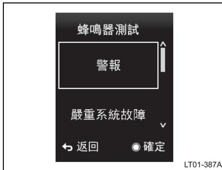
利用資訊顯示幕控制開關的上/下按鈕選擇一個您想要測試的項目，然後按下設定按鈕以聆聽測試聲響。
